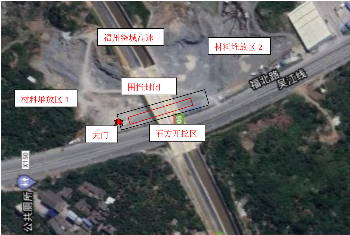
图 3- 11 施工临建设施平面布置图
