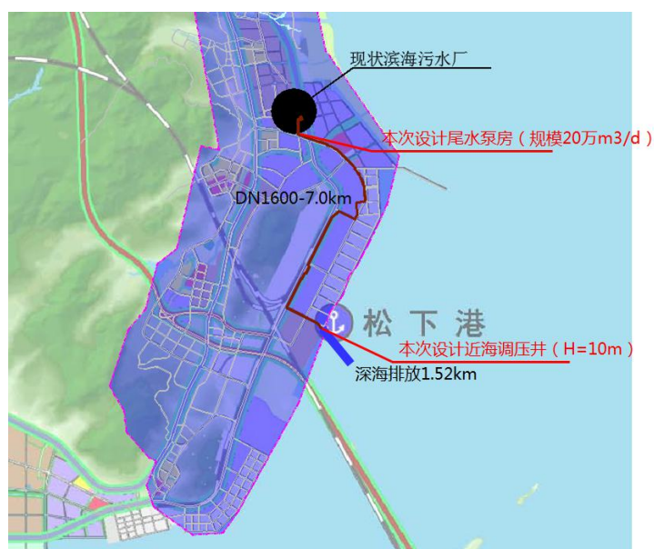
图 5-4 尾水系统总体设计-方案三
