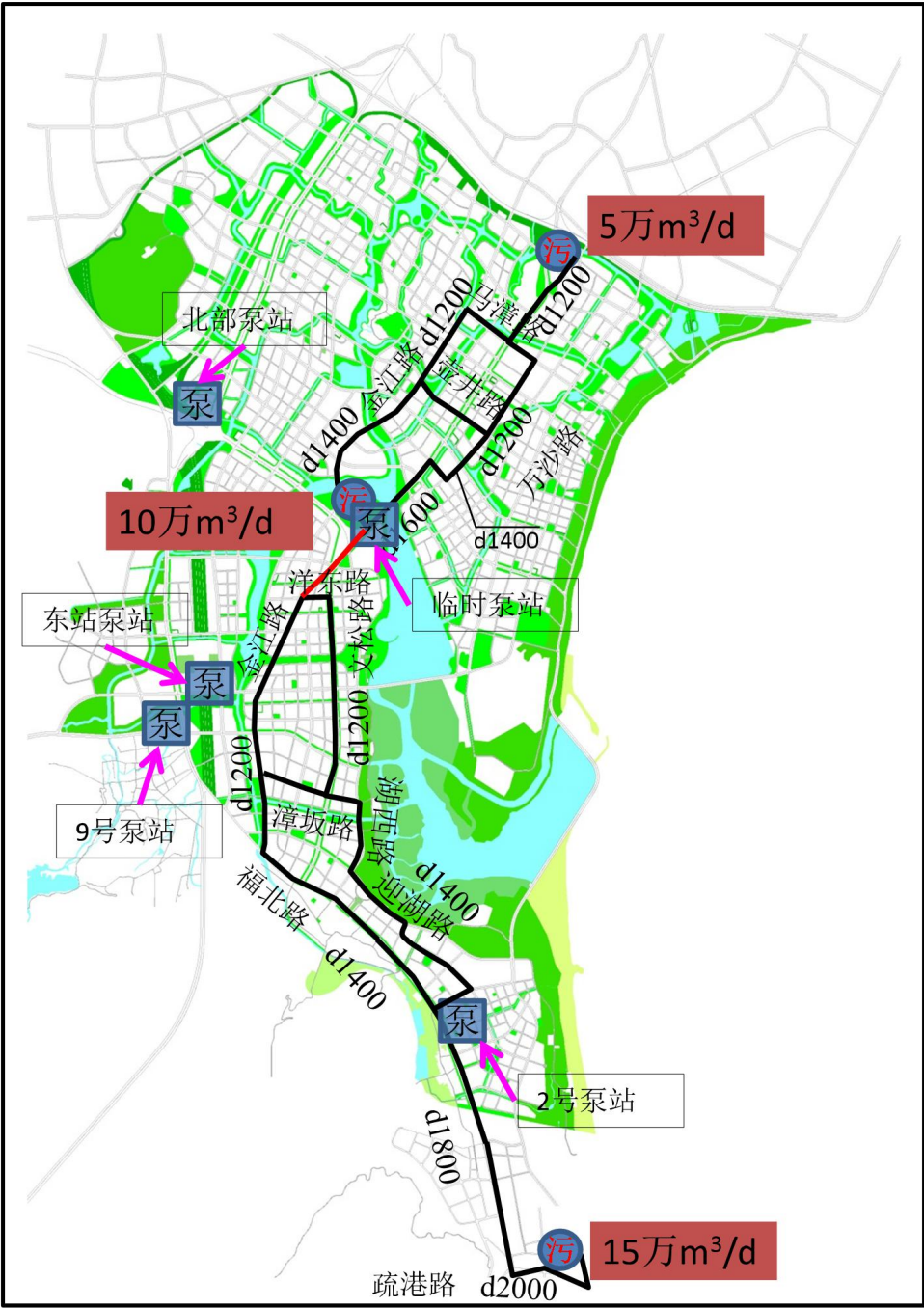
图 2-3 滨海新城核心区污水干管布置
