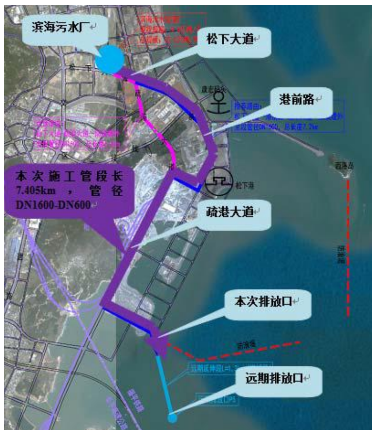
图 3-2 现状滨海污水厂尾水管道平面布置图
